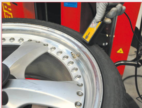
instrumento para interceptar sensor y datos relativos
