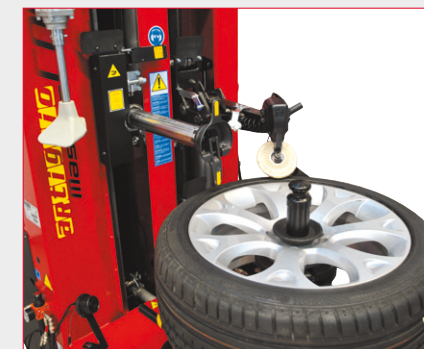
posicionamiento automático de las herramientas para ciclo manual
