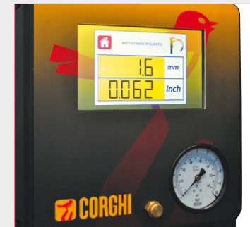
datos profundidad banda de rodadura: en fondo amarillo está próximo al umbral límite
