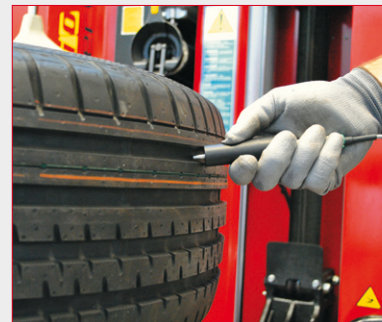
medición de la profundidad de la banda de rodadura
