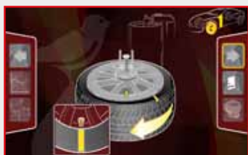
Procedimiento de Match-Mounting llanta-neumático
