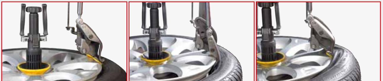
Procedimiento de desmontaje del talón superior
