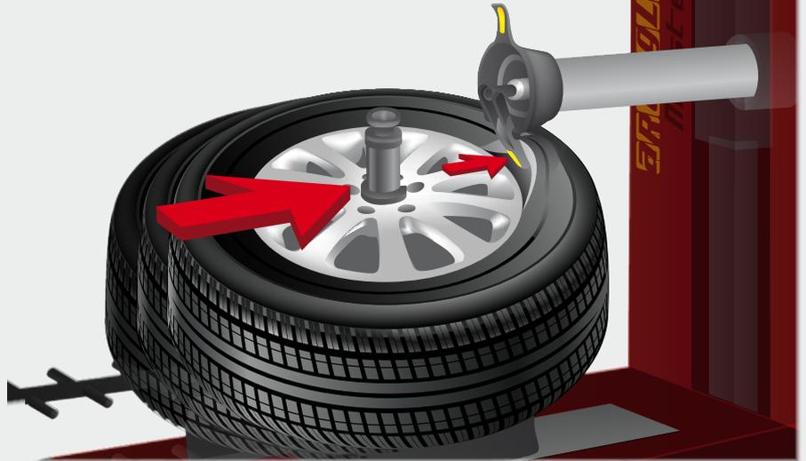
**BÚSQUEDA AUTOMÁTICA DEL TALÓN DEL NEUMÁTICO SIN NINGÚN CONTACTO CON LA LLANTA, INDEPENDIENTEMENTE DE SU FORMA**
