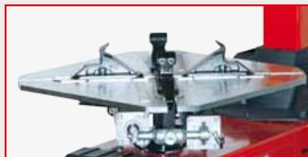
**Etau** avec double vérin pneumatique en mesure de bloquer solidement tous les types de jantes.
