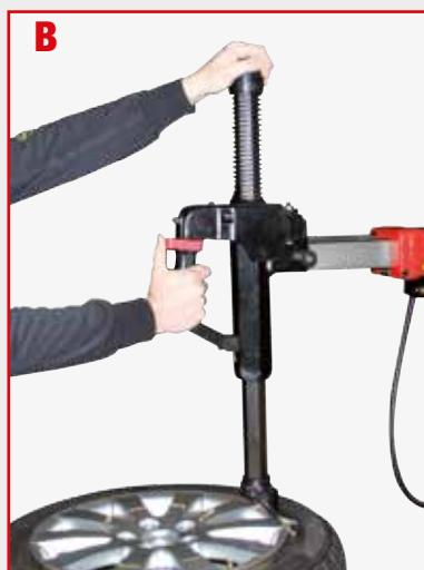
Blocage pneumatique **simultané** du bras horizontal et vertical porte-tourelle avec mise en place automatique de cette dernière dans la meilleure position de travail. Automatique (A) et Manuel (B).
