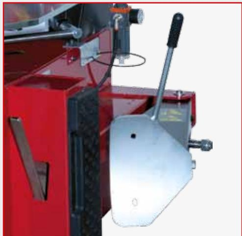
El **potente destalonador** se acciona por un **cilindro (D. 186 mm.) de doble capa en acero inoxidable**. Una protección plástica especial (bajo pedido) para la pala, permite salvaguardar las llantas de aluminio durante la operación de destalonadura.
